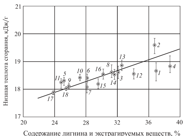
Рис. 2. Зависимость низшей теплоты полного сгорания образцов древесины от суммарного содержания лигнина и экстрагируемых веществ: 1 — ель; 2 — сосна; 3 — лиственница; 4 — кедр; 5 — бук; 6 — ясень; 7 — клен; 8 — дуб; 9 — береза; 10 — граб; 11 — осина; 12 — сосна тхонгкарибэ; 13 — ель ваншам; 14 — эвкалипт бачдан; 15 — акация кеотайтыонь; 16 — акация кеолай; 17 — каштан; 18 — ильм карагач
