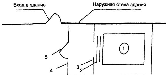
1 — лифт для пожарных; 2 — противопожарная дверь шахты лифта для пожарных с пределом огнестойкости EI 60; 3 — ограждающие конструкции шахты с пределом огнестойкости REI 120; 4 — противопожарные перегородки 1-го типа, ограждающие лифтовый холл (тамбур); 5 — противопожарная дверь 2-го типа лифтового холла (тамбура) в дымогазонепроницаемом исполнении
