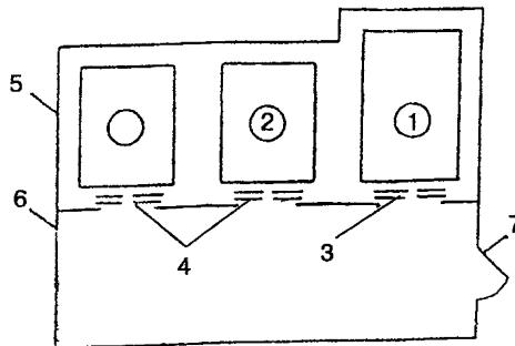
1 — лифт для пожарных; 2 — пассажирские лифты; 3 — противопожарная дверь шахты «лифта для пожарных» с пределом огнестойкости EI 60; 4 — противопожарная дверь шахты пассажирских лифтов с пределом огнестойкости EI 60; 5 — ограждающие конструкции общей шахты с пределом огнестойкости REI 120; 6 — противопожарные перегородки 1-го типа, ограждающие лифтовый холл (тамбур); 7 — противопожарная дверь 2-го типа лифтового холла (тамбура) в дымогазонепроницаемом исполнении
